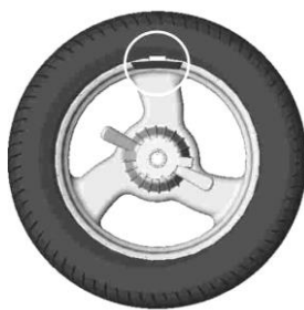
Рисунок 6.5 – Груз установлен в «12 часов»
