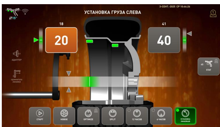
в – установка груза линейкой
